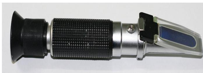
**Fig: A Brix Refractometer.**
